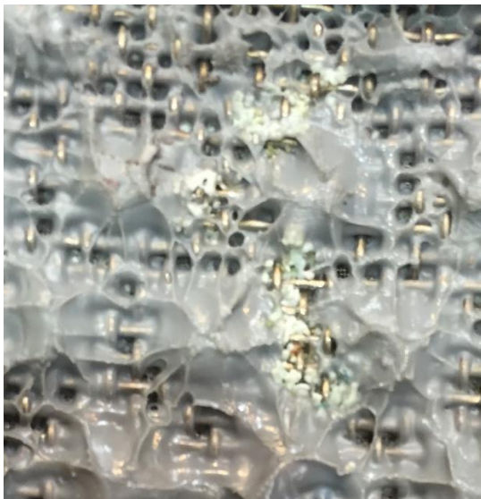
Figuur 5: Kit wordt door smeltzeef heen geperst
