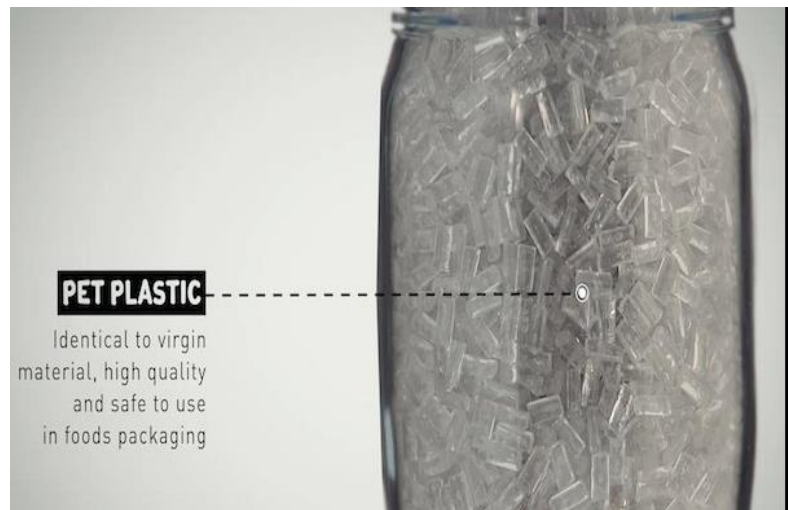
Figuur 7 Met de nieuwe technologie van Ioniqa wordt PET-afval afgebroken tot basismoleculen van hoge kwaliteit
